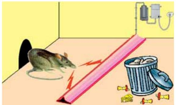
Принцип действия ОЗДС заключается в болезненном, но не смертельном электрошоковом воздействии, который получает зверек при попытке проникновения на защищаемый объект. Грызуны мигрируют - вся стая покидает помещения.
