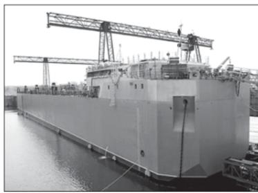
Зеленодольский судостроительный завод им. Горького (Республика Татарстан) направил на испытания в Северодвинск плавучий док «Свияга», построенный для обслуживания кораблей ВМФ РФ. «Свияга» предназначена для проведения докового осмотра и ремонта кораблей, а также для обеспечения транспортировки судов по внутренним водным путям. После испытаний док войдет в состав Северного флота ВМФ России.
